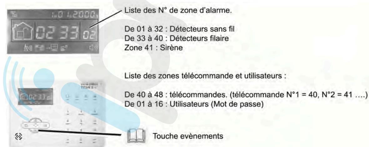
**Attention :** Auto-protection = Lorsqu'un détecteur n'est pas refermé convenablement et que sa LED se met à clignoter, il envoie un message d'alerte à la centrale. Celle-ci va automatiquement se mettre en alarme, quelle soit armée totalement, partiellement ou désarmée. L'écran affichera alors le numéro de la zone concernée. Pour arrêter le hurlement de la sirène, désarmez depuis la télécommande luxe ou le clavier tactile de la centrale (1 2 3 4 + #).
