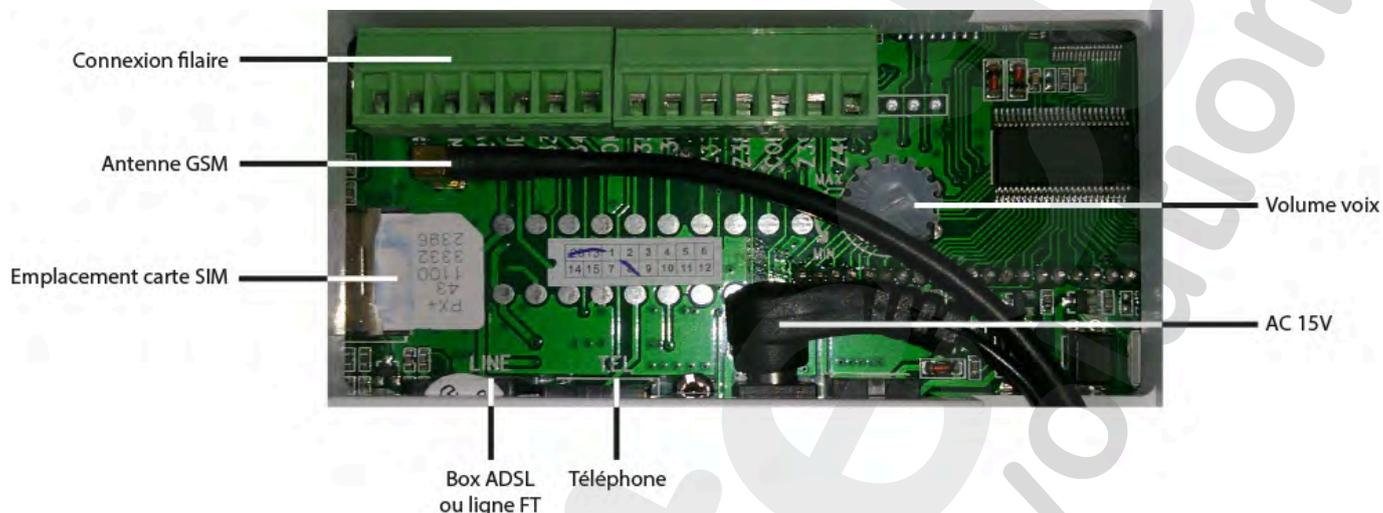
**Attention :** L'antenne GSM et l'emplacement carte SIM sont valables uniquement pour les modèles GSM.
